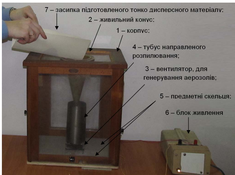
Рис. 1. Установка для генерування завислих у повітрі мінеральних частинок та проведення експериментального моделювання процесів взаємодії соляних та глинистих аерозолів
