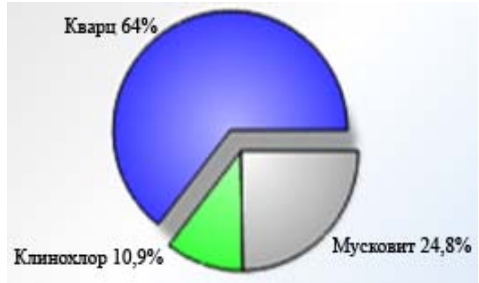
Рис. 3. Зображення порового простору в сланцевих породах із визначенням розміру пор (а); мінеральний склад сланцевої породи за даними рентгенофракційного дифрактометра (б)
