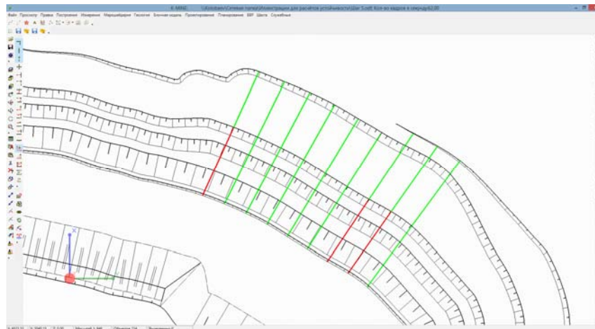
Рис. 1. Візуалізація ділянки гранично-припустимого борта кар'єру за показниками стійкості
